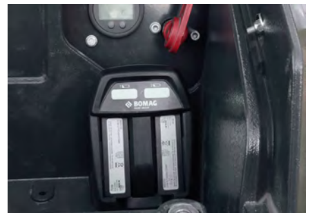
Integriertes Ladegerät (optional) Zweiten Akku laden im Funkbetrieb
