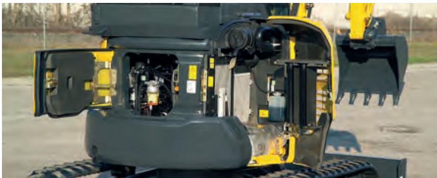
Hintere Wartungsklappe für schnelle Motorinspektion und Betankung, einfachen Wartungszugang, leichte Reinigung der Kühler und guten Zugang zur Batterie
