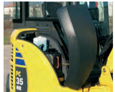
Vordere Wartungsklappe: leichtes Betanken
