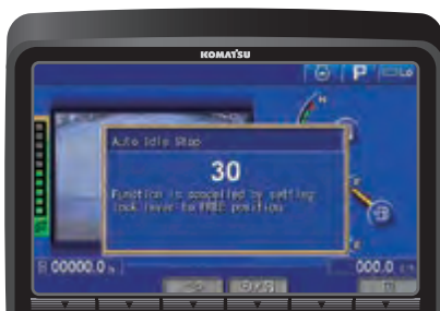
Eco-Anzeige, Eco-Hinweise, eine einstellbare Leerlaufabschaltung und die neue Drehzahlrückstellung senken den Kraftstoffverbrauch
