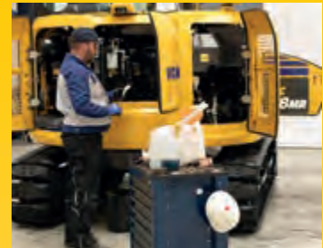
Alle wichtigen Wartungspunkte sind bequem vom Boden aus erreichbar
