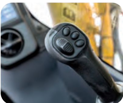
Komfortable, ergonomische und präzise Steuerung: Joysticks mit Proportionaltastern für die Anbaugerätesteuerung
