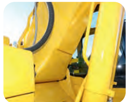
Gegossener Auslegerfuß und einteilige Platten am Ausleger
