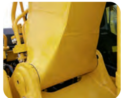
Gegossener Auslegerfuß und einteilige Platten am Ausleger
