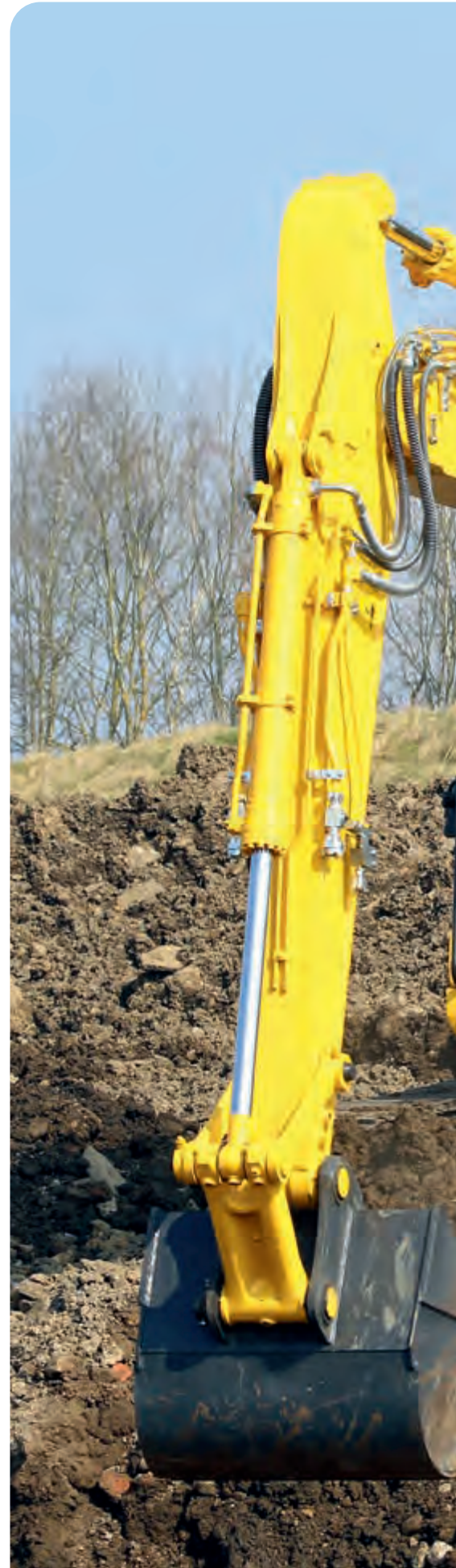
Zwei optionale Hydrauliksteuerkreise ermöglichen den Einsatz von zahlreichen Anbaugeräten
