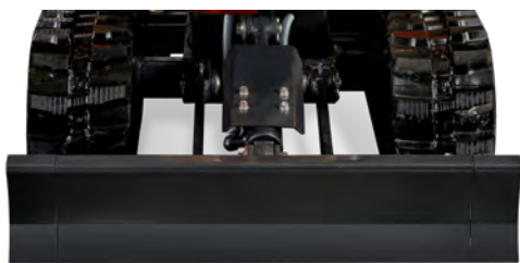
Ausgefahrener Unterwagen 840 mm – Mehr Standfestigkeit
