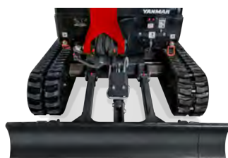
Ausgefahrener Unterwagen: 1170 mm
