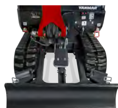
Eingefahrener Unterwagen: 980 mm
